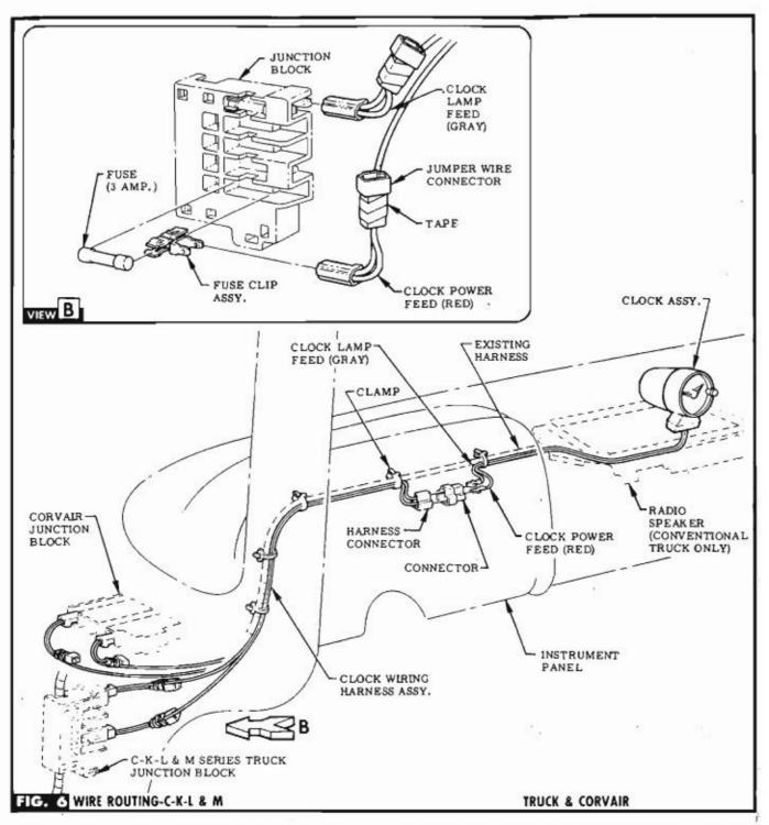
STEP 7 INSTALL FUSE CLIP & FUSE IN JUNCTION BLOCK, PLUG IN CONNECTORS ON CLOCK WIRING HARNESS & TAPE JUMPER CONNECTORS. SEE VIEW B.
